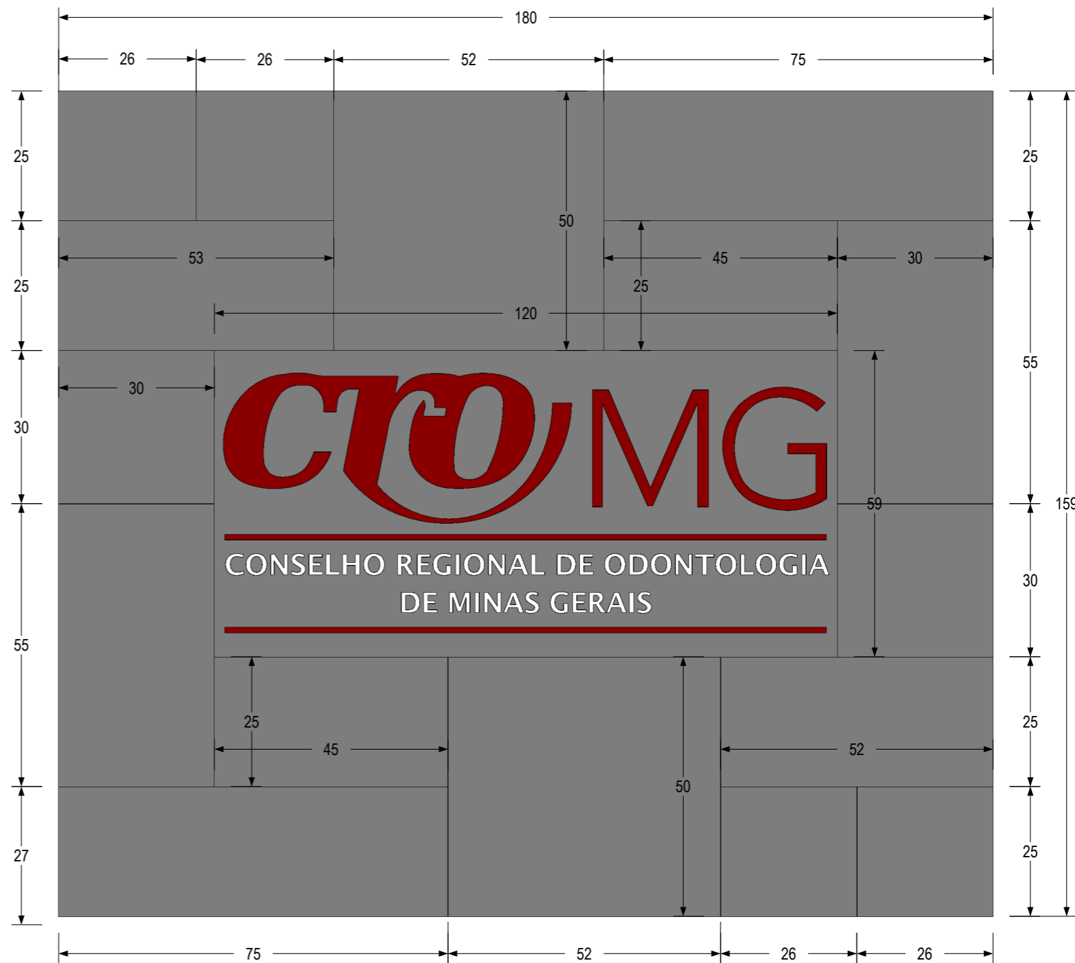
DETALHAMENTO DO PAINEL PRINCIPAL
